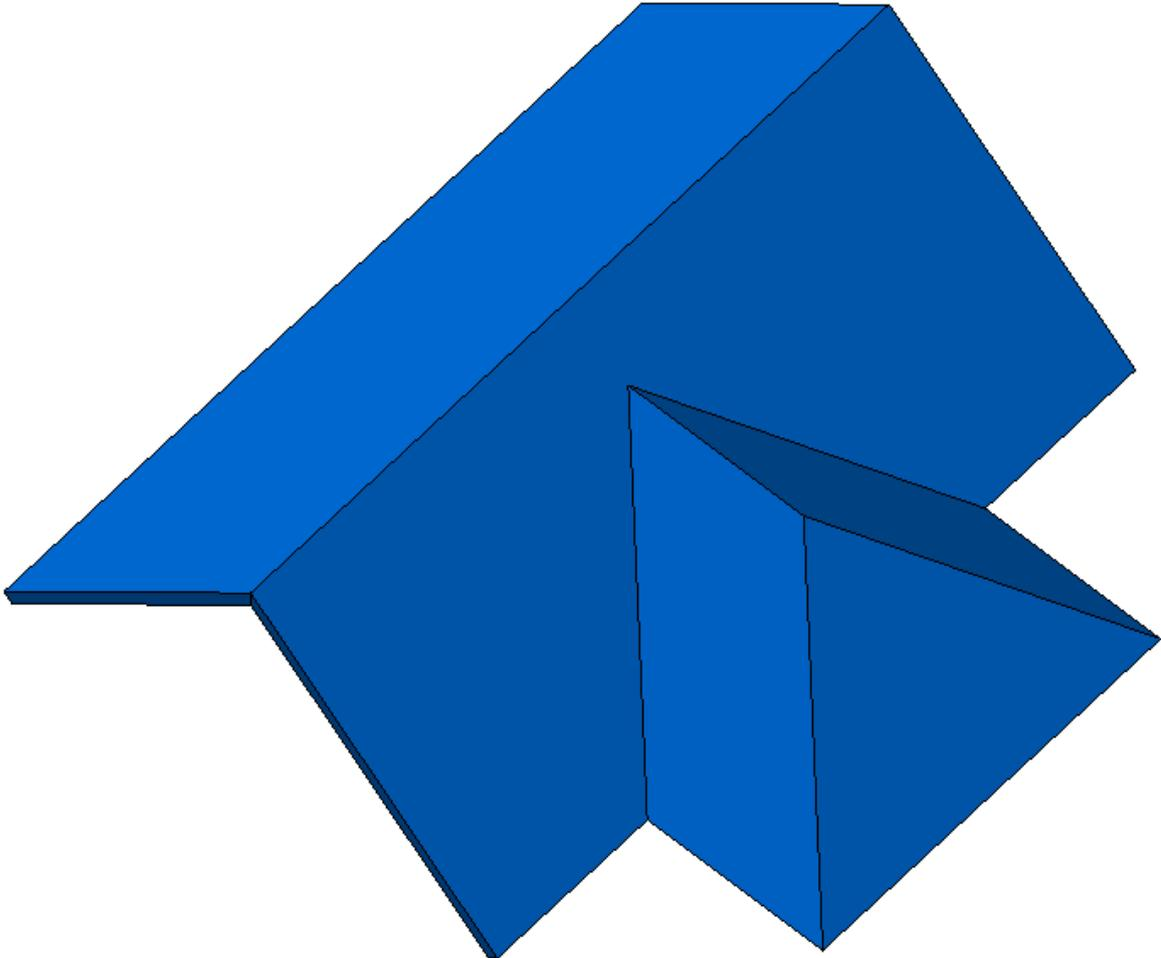
Dieses Dach wurde durch eine Polylinienvorkonstruktion umgewandelt. Die Dachflächen links und rechts habe ich dann über die Firstgriffe nach außen gezogen, um einen Giebel zu erzeugen. Nun soll am Anbau ein Krüppelwalm konstruiert werden.
