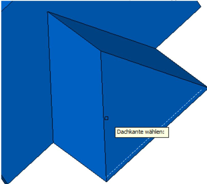
...und definieren eine Höhe dieser Dachkante. In diesem Beispiel 2 für 2 Meter.
