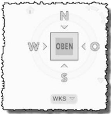
Mit dem ViewCube können Sie die Ansicht bzw. Perspektive wechseln, während Sie in einem Befehl arbeiten. Er funktioniert sozusagen als „transparenter Befehl“ und erfordert nicht das Abbrechen eines andren aktiven Befehls.
