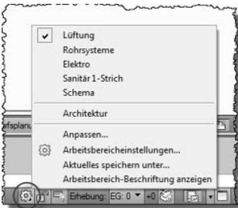
Wählen Sie einen Arbeitsbereich aus, um nur die für einen bestimmten bereichsspezifischen Vorgang benötigten Menüs, Werkzeugkästen und Paletten anzuzeigen. Die Standardarbeitsbereiche sind: Lüftung, Rohrsysteme, Elektro, Sanitär, Schemata und Architektur.
