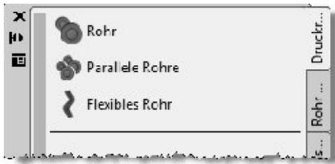
Werkzeugpaletten enthalten Werkzeuge zum Erstellen von Luftkanälen, Rohren und Elektroschalttafeln eines bestimmten Typs und Inhalten, wie Beschriftungen und Bauteillisten. Die Standardwerkzeugpaletten hängen vom ausgewählten Arbeitsbereich ab: Lüftung, Rohrsysteme, Elektro, Sanitär, Schemata und Architektur. Auf einer Projektpalette können projektspezifische Werkzeuge gruppiert werden. Paletten und Werkzeuge können angepasst werden.
