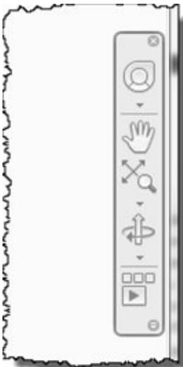
Die Navigationsleiste bietet Ihnen Schnellzugriff zu verschiedenen Formen des Navigationsrades, zur Zoom- und Pan-Funktion, zum 3D-Orbit und zum Recorder.
