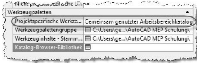
Hierzu legt AutoCAD MEP automatisch ein Werkzeugpaletten-Verzeichnis in der Projektstruktur an. Alternativ kann die Funktion *Arbeitsbereichskatalog pro Benutzer* ausgewählt werden. In diesem Fall werden die Werkzeugpaletten-Verzeichnisse in den von Windows definierten Benutzerpfaden erzeugt.
