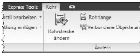
Wenn Sie Objekte im Zeichnungsbereich auswählen, wird in der Multifunktionsleiste eine kontextabhängige Registerkarte angezeigt, die nur die für die Auswahl relevanten Befehle enthält.
